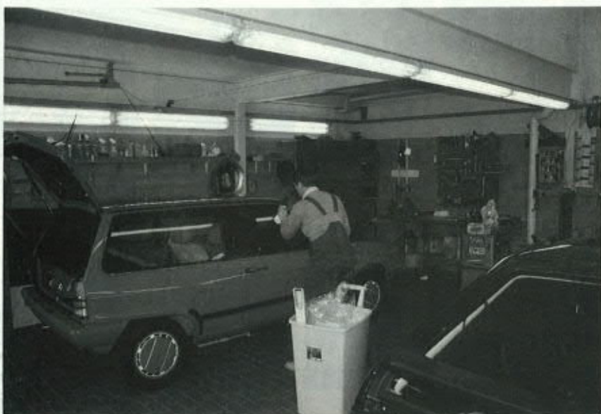
Für die Gebrauchtwagenaufbereitung stehen zwei Kopfstände mit Hebebühnen zur Verfügung. Eine Hebebühne ist mit Höhenbegrenzung ausgerüstet, da die Decke relativ niedrig verläuft.
